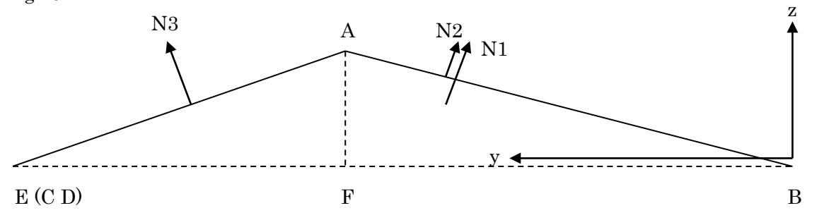
まず各辺の実寸は Sec.6 と同様である。  $AB = AC = AD = L$      $BC = DB = \sqrt{3}L$
