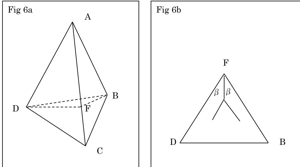
図 6a で  $AB = AC = AD = kL$   $BC = CD = DB = L$  とする。辺 AC に点 D から下した垂線の足を F とする。図 6b で側面の板材①どうしのなす角を図のように定め、 $\tan \beta$  を求める。三角形 ABC の面積について次の式が成り立つ。
