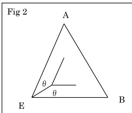
今度は板で作るので、角材よりもはるかに簡単である。同じ大きさの正三角形の板の縁を角 AEB の半分の角度  $\theta$  ですべて斜めに切り落とすか削るかする。以後、この角度  $\theta$  を面接合角(Plate Joint Angle)と呼ぶ。
