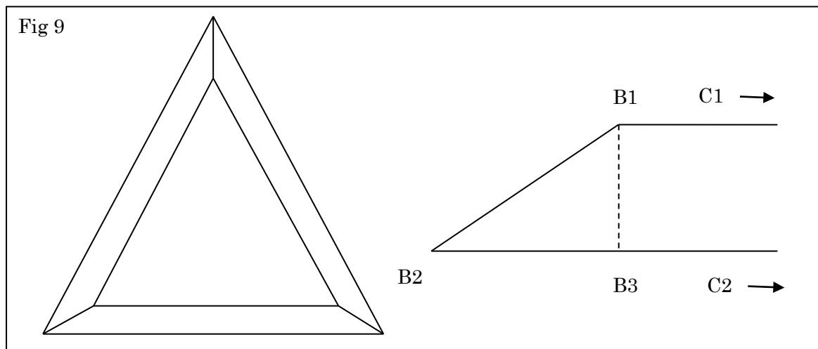
枠は 3 本の部材②からなる。図 9 で、 $B1C1 = L$      $\angle B1B2B3 = 30^\circ$      $B1B3 = M$  であるから、
