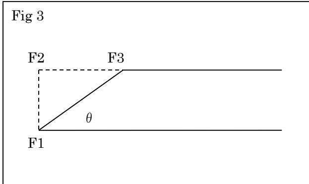
図 3 で  $F_1F_2$  が板の厚さで既定であり、そのときの  $F_2F_3$  の長さが問題になるので、 $\tan \theta$  よりはその逆数を求めておいたほうがよい。 $\frac{1}{\tan \theta} = \sqrt{2}$  であるので、 $F_2F_3$  を板の厚さの 1.41 倍にすればよい。
