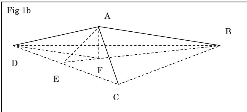
部材 Q の垂直接合角は角 DAF すなわち  $\beta$  となる。しかし、点 F は 3 角形 BCD の外心なので  $BF=DF$  であるから 3 角形 ADF と先の 3 角形 ABF は合同なので、 $\beta=\alpha$  となる。従って部材 P と Q の垂直接合角は等しい。次に接合深さを調べる。
