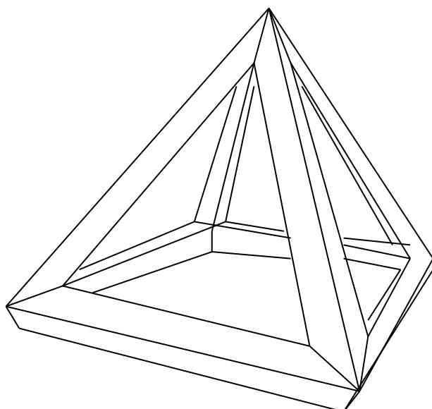
写真は廃材で作った正4角錐。廃材の断面は正方形でないので墨出しと切削は面倒であった。
