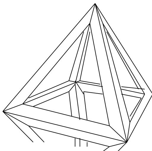
しかし、実際に 12 本の部材を用意するのは正 6 面体同様大変で、作ったとしても座りが悪い。風が吹いたら転がっていきそう。そこで、座りが良いと思われる、正 4 角錐を作った。部材は正 8 面体と同様のものが 4 本、残りの 4 本は片面の細工が正 8 面体と同様で、片面は接合深さを 0 にすればよい。その墨出しは簡単である。
