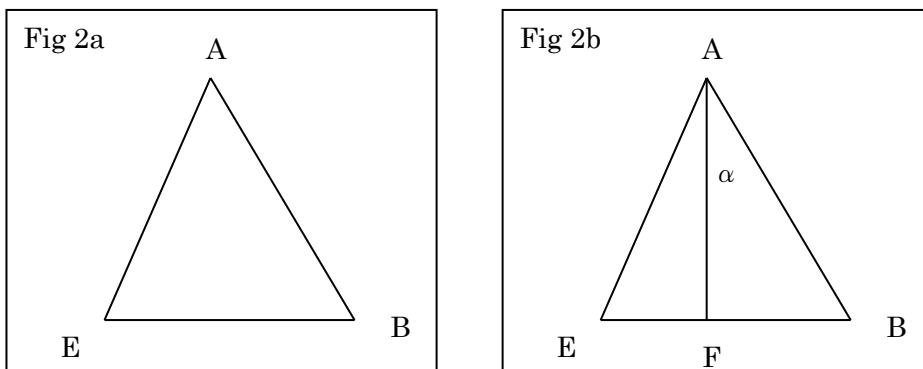
A から辺 BE に垂線を下し、その足を F とする。直線 AF は3角形 BCD の回転に関する対称軸であり、点 F は3角形 BCD の外心であるが、3角形 BCD は正3角形なので、点 F は3角形 BCD の重心にもなっている。そのため計算は楽である。 $\angle BAF = \alpha$  とする。以後この角度を垂直接合角(Vertical Joint Angle)と呼ぶことにする。
