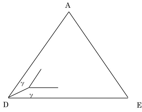
$\angle ADE = 2\gamma$  として  $\frac{1}{\tan \gamma}$  を求める。これが底面とそれに繋がる正三角形の縁の切り込みを決める。
